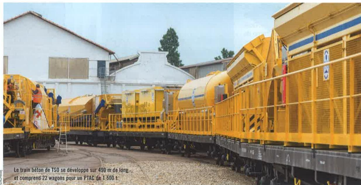
Le train béton de TSO se développe sur 490 m de long et comprend 22 wagons pour un PTAC de 1 500 t.
